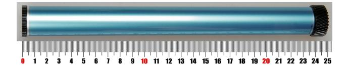
**3.** Покрытие на барабане прозрачное (свет отражается от алюминиевой поверхности барабана), это покрытие имеет при обычном освещении голубые оттенки Общая длина барабана 252 мм.
